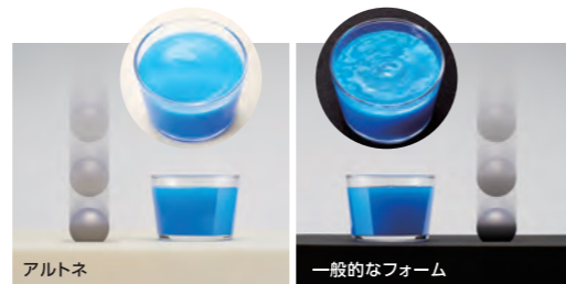
写真/一般的なウレタンフォームとの衝撃吸収力比較試験 (鉄球落下時の衝撃を容器に入れた液体の状態を検証)
