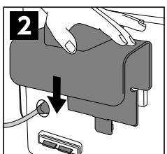
つめを持ち上げたままフックを下に押し込むようにスライドさせ、取り外します。
