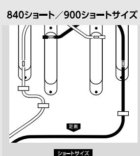
スマールチェンジ用送風チューブ(白)は、2ヵ所、スマールチェンジ用送風チューブ(黒)は、1ヵ所のベルトを通してください。
