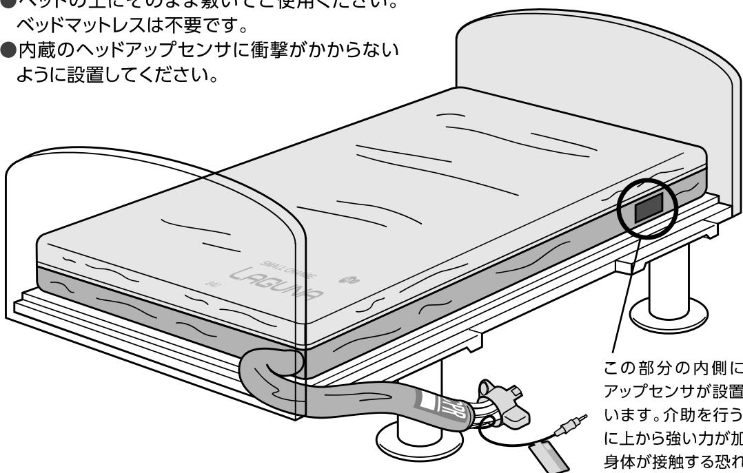
この部分の内側にヘッドアップセンサが設置されています。介助を行う際などに上から強い力が加わると身体が接触する恐れがありますので注意してください。
