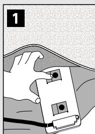
ベースシート底面の固定ベルト(2ヵ所)でセンサを固定します。
