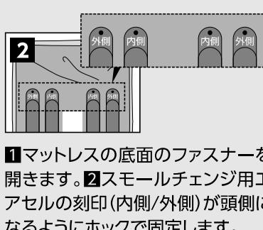
1マットレスの底面のファスナーを開きます。2スマールチェンジ用エアセルの刻印(内側/外側)が頭側になるようにホックで固定します。
