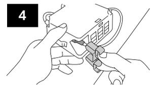
4 ヘッドアップセンサプラグ(緑色)挿入部にプラグロックを取り付けます。
