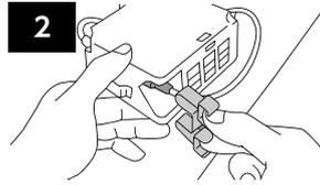
2 マットレス側面のファスナーを開いたら、ファンユニットに取り付けられているプラグロックを外します。
