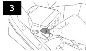
3 ファンユニットに接続されているプラグ(緑色)を引き抜き、ケーブルをファンユニットから取り外します。
