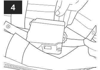
4 ファンユニットを固定しているベルトのホックを外し、ファンユニットから引き抜きます。
