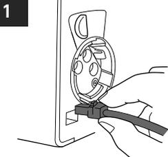
1 ヘッドアップセンサコネクタ(黒色)の上部の突起を押し込みながら引き抜きます。
