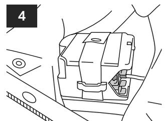
4 ファンユニットに固定ベルトを通し、ホックを取り付けます。
