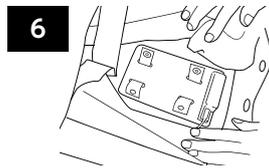
6 ヘッドアップセンサを固定しているベルトのホックを外し(2か所)、センサを引き抜きます。
