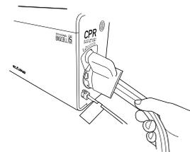
※送風チューブやヘッドアップセンサケーブルを持って無理に引っ張らないでください。送風チューブが抜けたり、ヘッドアップセンサコネクタ(黒色)の破損等の原因になります。
