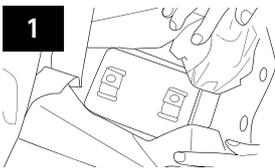
1 固定ベルト(2か所)でセンサを固定します。
