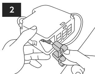
2 ヘッドアップセンサプラグ(緑色)挿入部にプラグロックを取り付けます。
