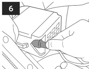
6 ヘッドアップセンサプラグ(緑色)を引き抜き、ファンユニットを取り外してください。
