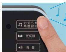
お好みの角度（例えば、35度の角度）に背上げをして「お知らせ角度設定」ボタンを押すと、その角度が記憶されます。次回以降、背上げを行う時、その角度に到達すると報知音でお知らせします。
